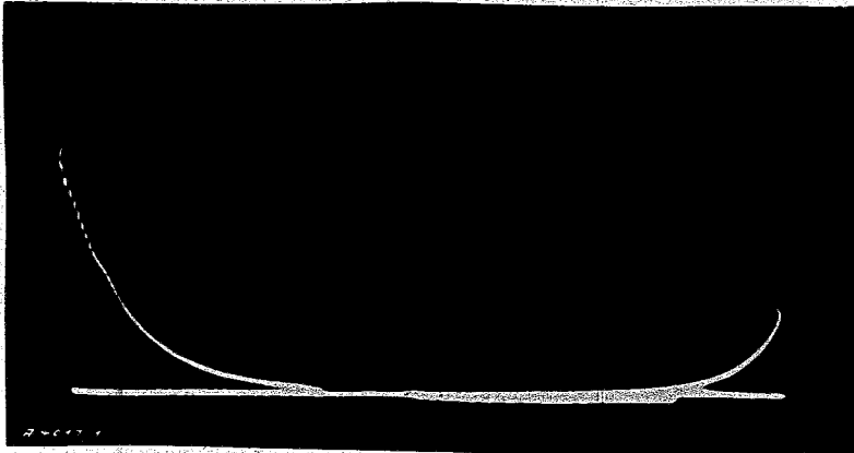
Bild 3: Beim Einspritzbeginn abgebrochenes Indikalordiagramm
