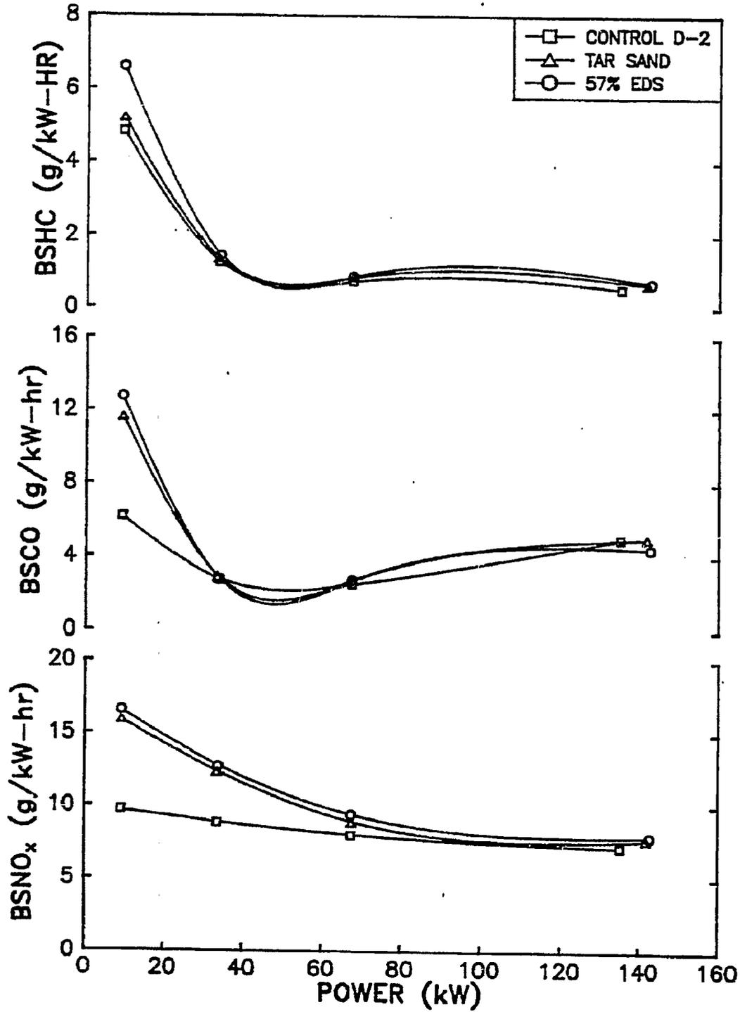
FIGURE 6.31. BRAKE SPECIFIC EMISSIONS AT 1400 RPM,
