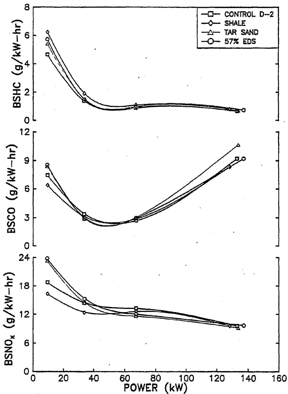
FIGURE 6.4. BRAKE SPECIFIC EMISSIONS AT 1400 RPM
