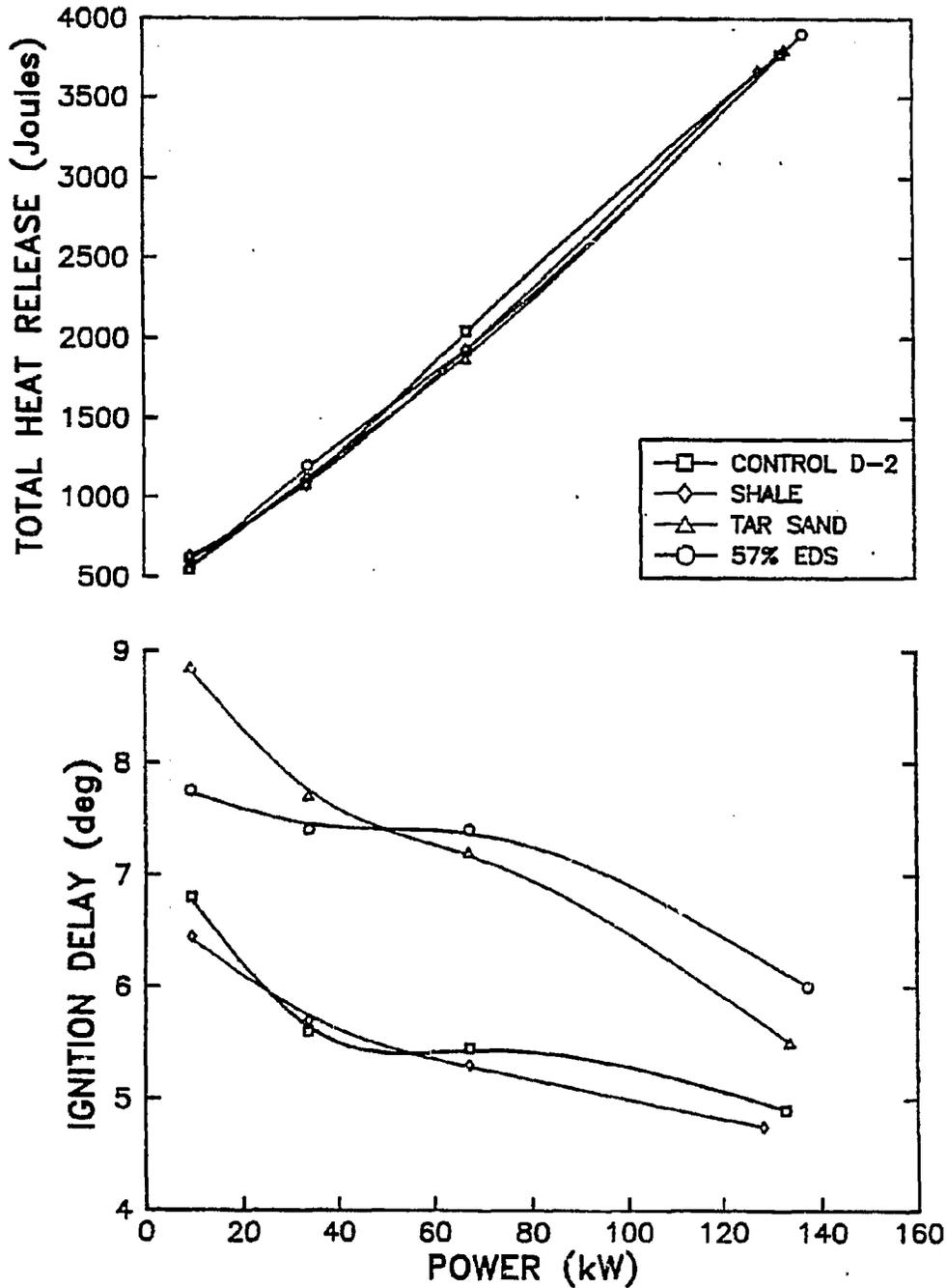
FIGURE 6.11. HEAT RELEASE RATE AND IGNITION DELAY FOR ALL FUELS AT 1400 RPM
