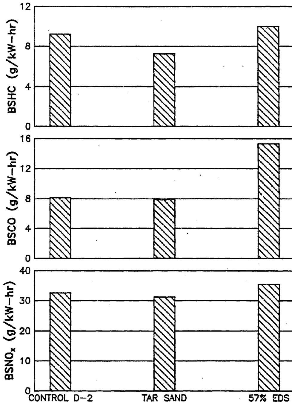
FIGURE 6.41. BRAKE SPECIFIC EMISSIONS AT IDLE, PHASE II SIMULATED AIR-TO-AIR AFTERCOOLER AND HIGH PRESSURE FUEL INJECTION SYSTEM
