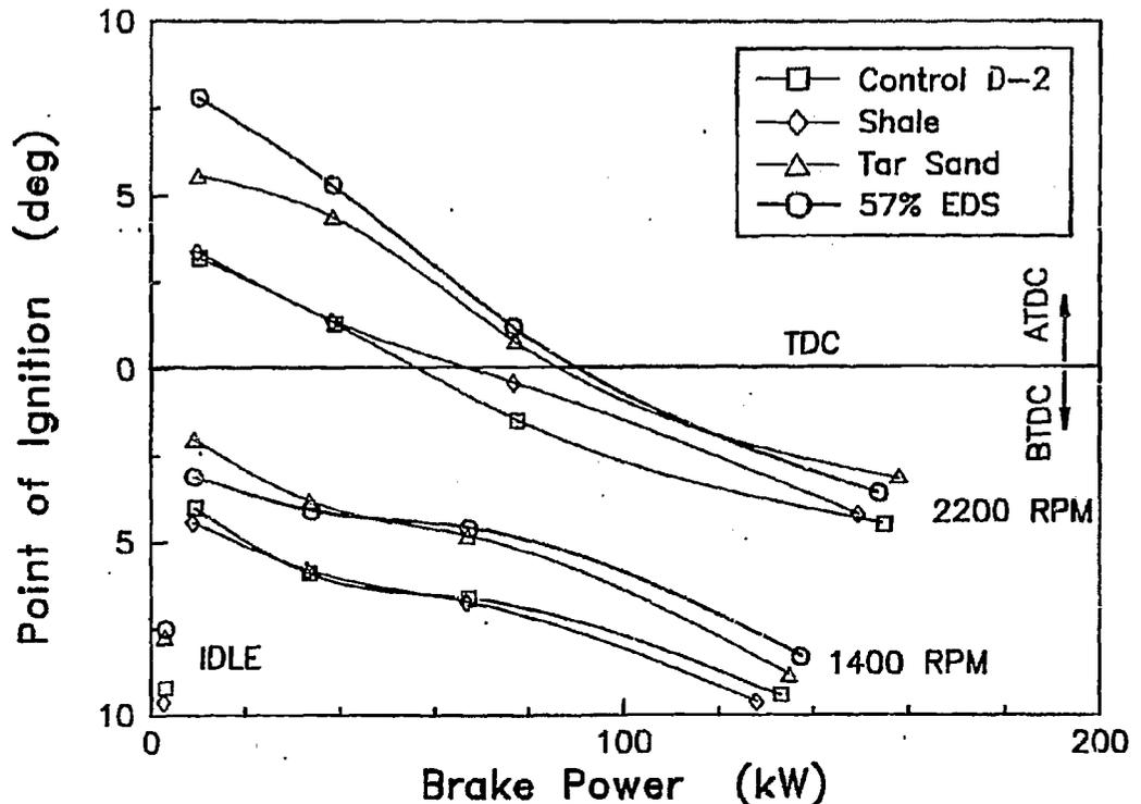
FIGURE 6.17. POINT OF IGNITION AND BRAKE POWER AT EACH ENGINE SPEED
