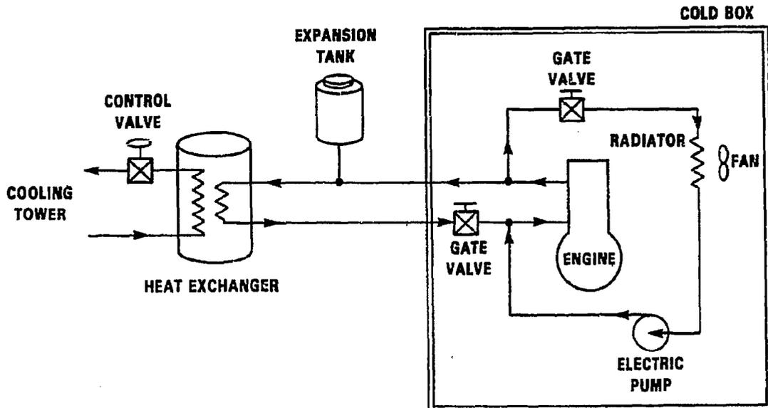
FIGURE 5.4. SCHEMATIC OF THE COOLING SYSTEM
