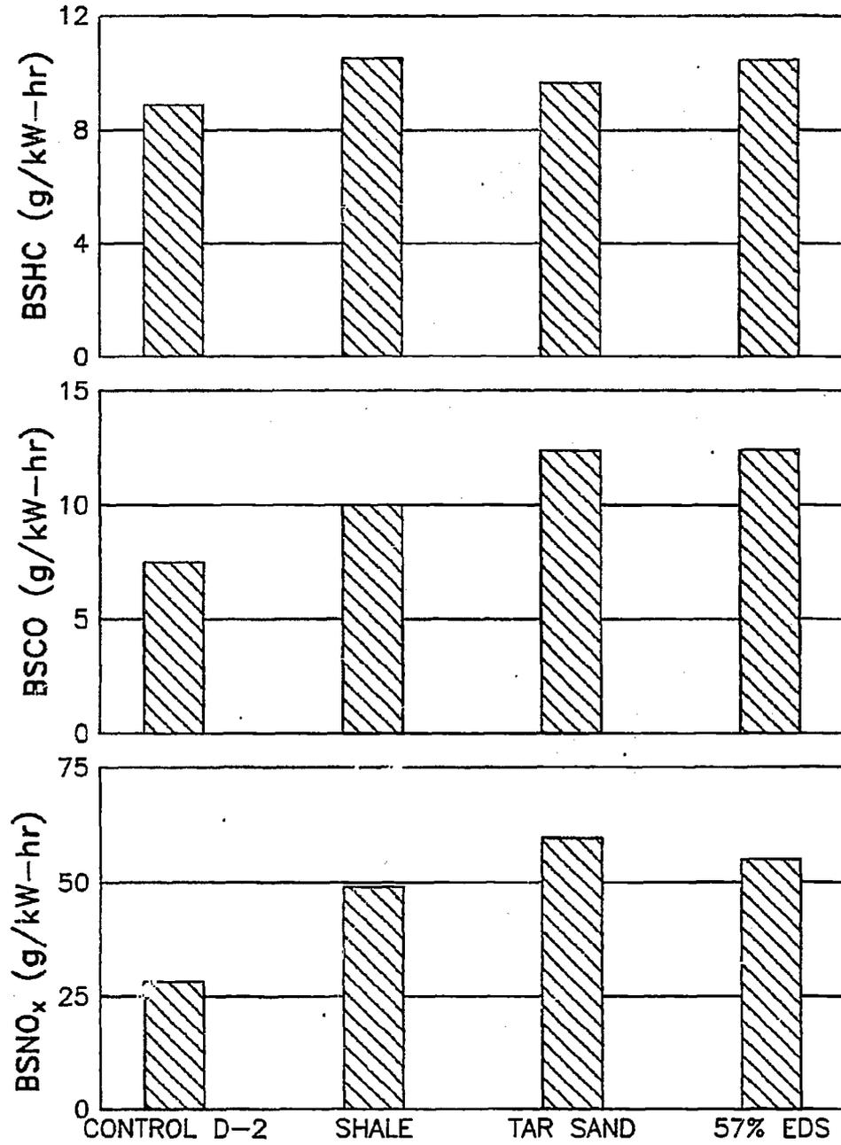
FIGURE 6.6. BRAKE SPECIFIC EMISSIONS AT IDLE
