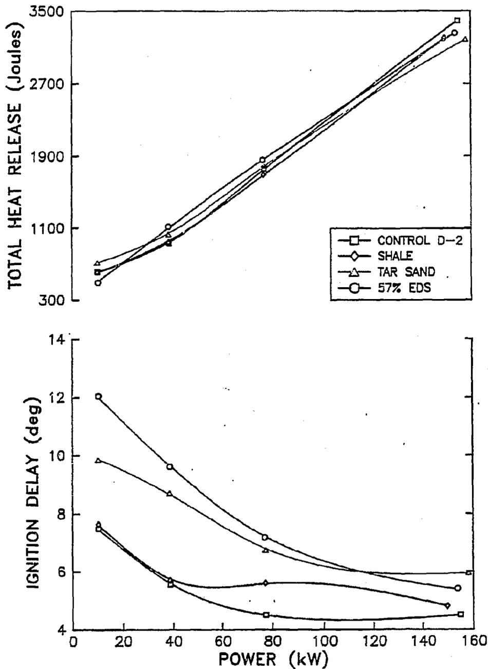
FIGURE 6.12. HEAT RELEASE RATE AND IGNITION DELAY FOR ALL FUELS AT 2200 RPM
