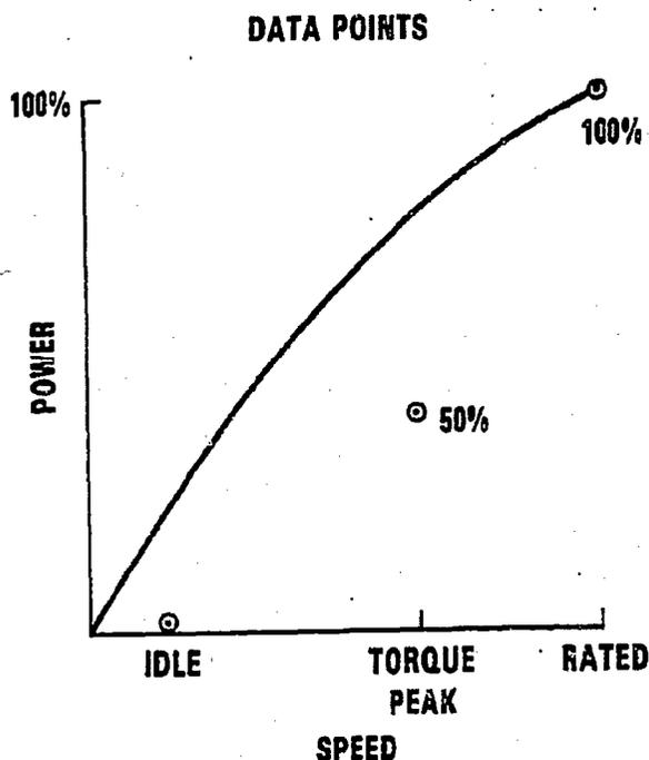
**FIGURE 5.8. SCHEMATIC OF THE COAL LIQUID BLEND SCREENING TEST DATA POINTS**
