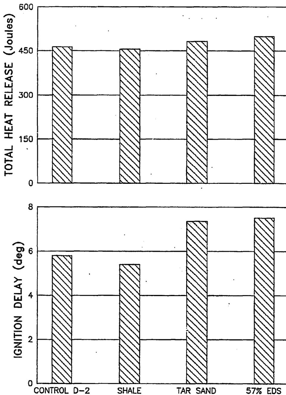
FIGURE 6.10. HEAT RELEASE RATE AND IGNITION DELAY FOR ALL FUELS AT IDLE CONDITION
