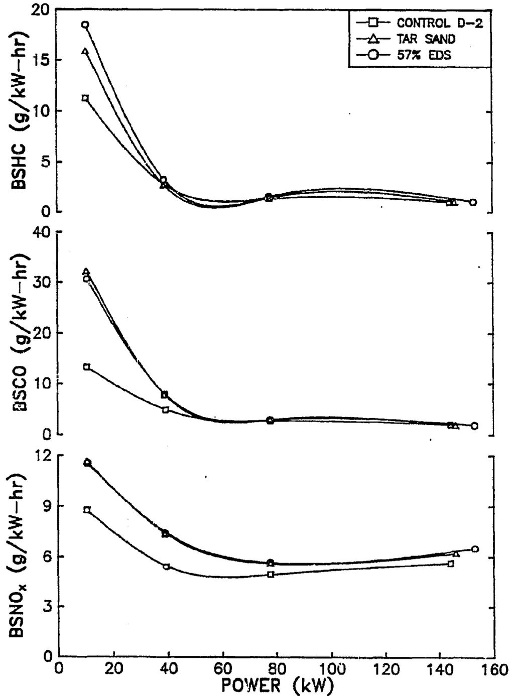
FIGURE 6.29. BRAKE SPECIFIC EMISSIONS AT 2200 RPM,
