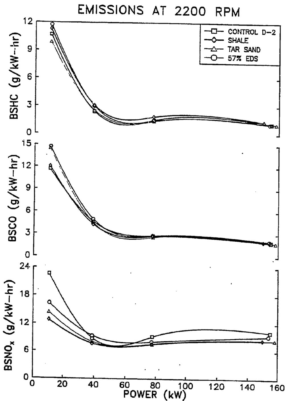
FIGURE 6.2. BRAKE SPECIFIC EMISSIONS AT 2200 RPM
