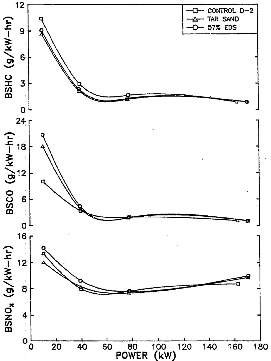
FIGURE 6.37. BRAKE SPECIFIC EMISSIONS AT 2200 RPM,
