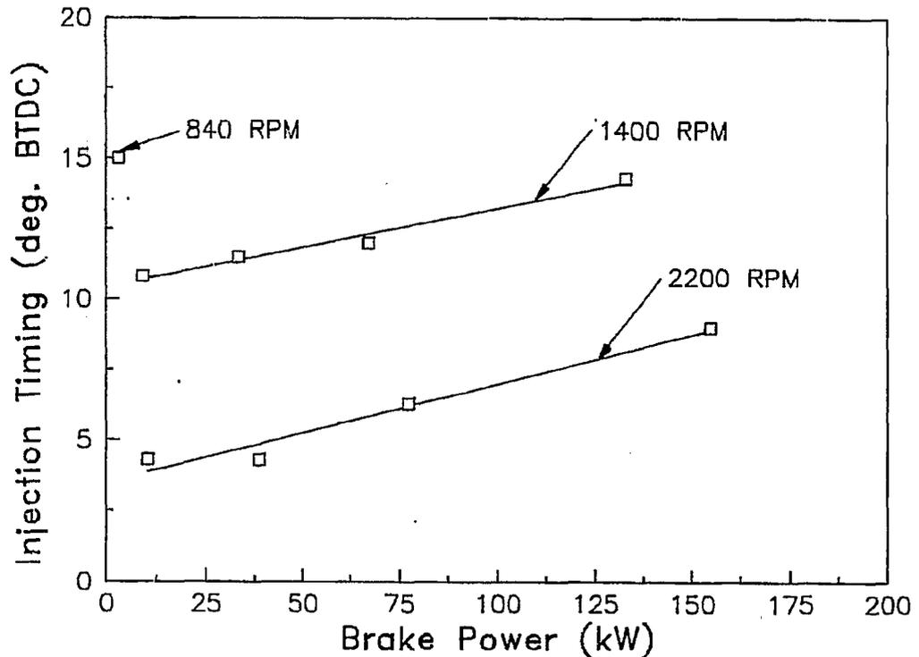
**FIGURE 6.16. INJECTION TIMING AND BRAKE POWER AT EACH ENGINE SPEED**
