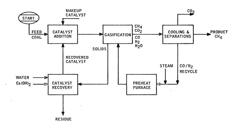
FIGURE 0.1-1 EXXON CATALYTIC COAL GASIFICATION PROCESS
