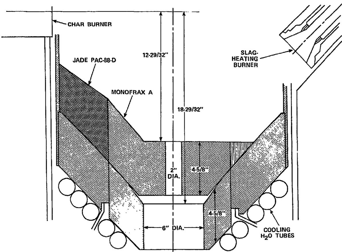
Figure 6-2. Bi-Gas Tap-Stone Arrangement
